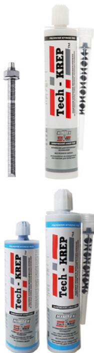
Химический анкер Tech-KREP PESF – двухкомпонентный химический состав на основе синтетической быстротвердеющей полиэфирной смолы, не содержащей стирол и не имеющий запаха. Применяется в сочетании с металлическими анкерными элементами (резьбовыми шпильками, болтами, арматурными прутками, сетчатыми гильзами для пустотелых материалов и т.п.).
