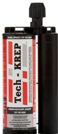
Химический анкер Tech-KREP TIT PE-500 – двухкомпонентный химический состав на основе синтетической высокомолекулярной эпоксидной смолы, не содержащей растворителей. Применяется в сочетании с металлическими анкерными элементами (резьбовыми шпильками, фундаментными болтами, арматурными прутками и т.п.).
