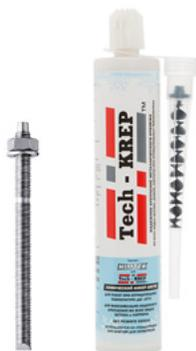
Химический анкер Tech-KREP Arctic - двухкомпонентный химический состав на основе синтетической эпокси-акрилатной смолы, не содержащей стирол и не имеющей запаха. Применяется в сочетании с металлическими анкерными элементами (резьбовыми шпильками, анкерными и фундаментными болтами, арматурными прутками и т.п.).
